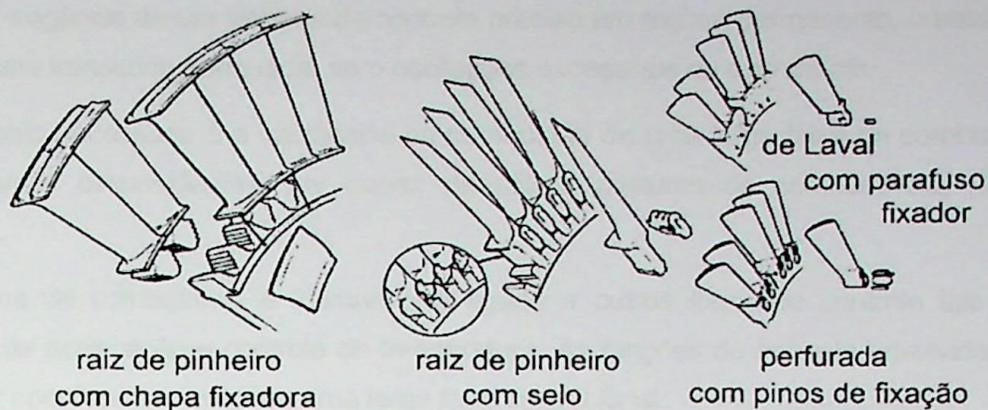
Figura 2.22 – Fixação das pás
