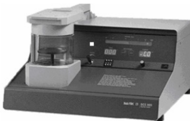
Figura (4) Equipamento utilizado para recobrimento com carbono ou deposição metálica sobre as amostras não condutoras
