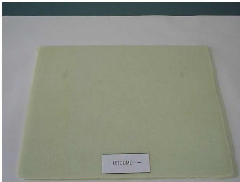
Figura 7 - Compósito vidro/epóxi de 8 camadas.
