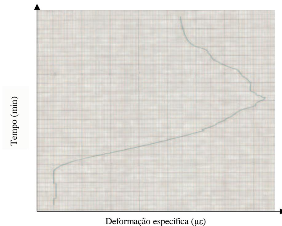
Figura 44b - Tempo em função da deformação específica para a amostra A3.
