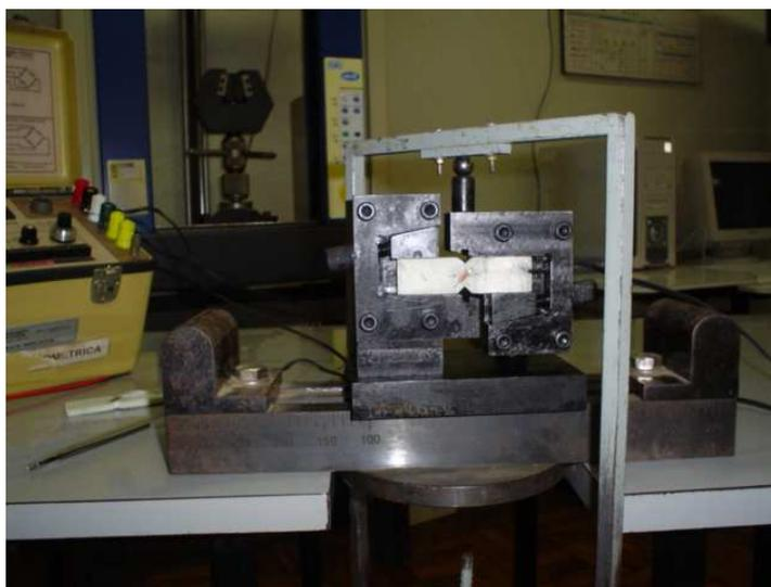
Figura 20 - Amostra no dispositivo para o Teste de Iosipescu.
