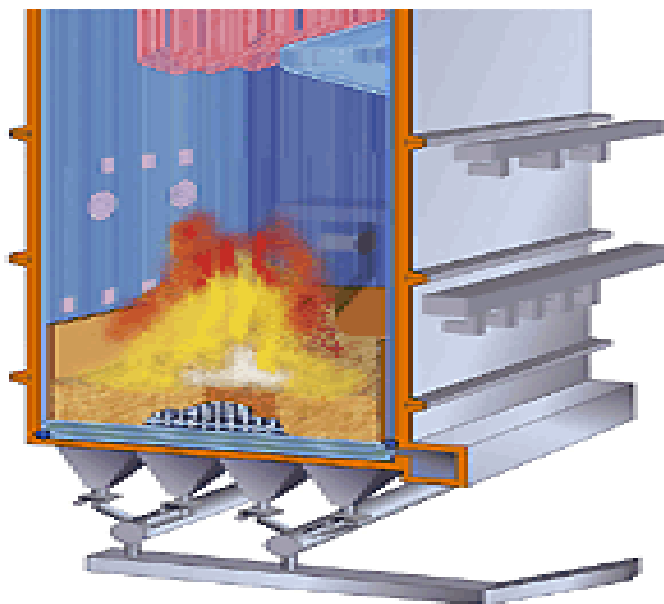
Figura 4.4: Câmara de Combustão da Caldeira de Leito Fluidizado Borbulhante. Fonte Kvaerner Pulping, 2005.
