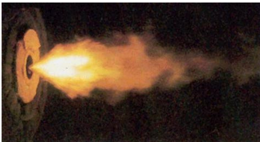
Figura 5.2: Chama de Queimador de Óleo. Fonte Teir, 2002.
