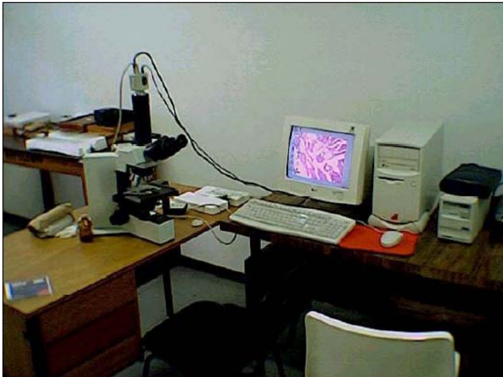
Figura 12- Sistema para processamento de imagens utilizando um microcomputador com software para análise de imagens.
