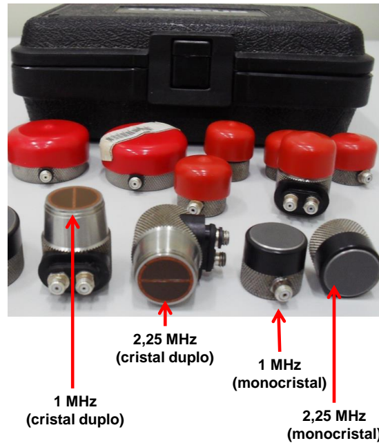
Figura 3-3: Sensores de ultrassom utilizados (Gonçalves, 2013).
