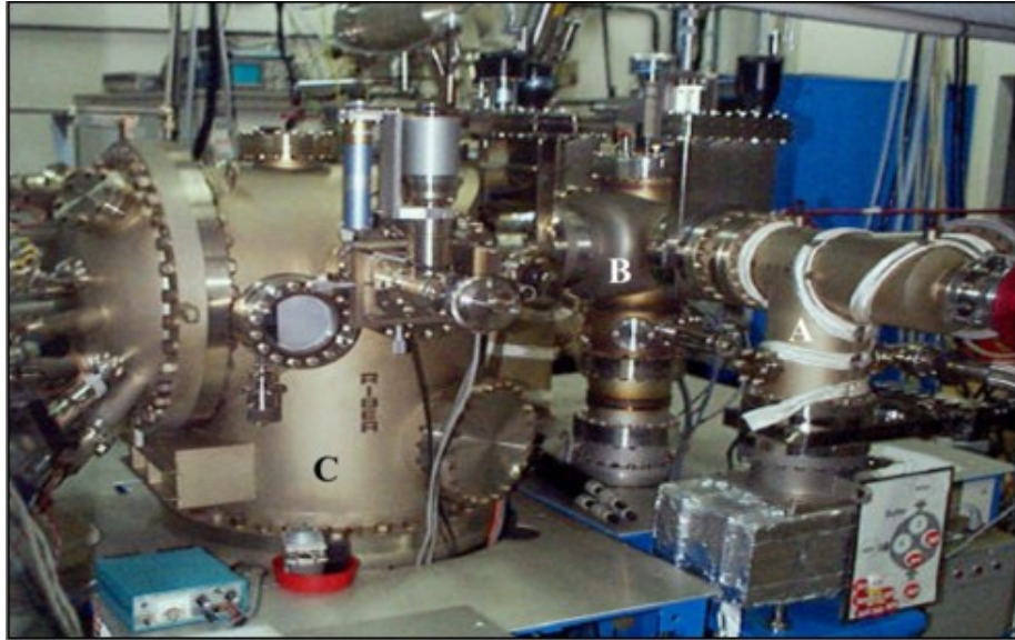
Figura 5.3 - Sistema Riber MBE utilizado pelo DF-ICEX-UFMG no crescimento das amostras [5].
