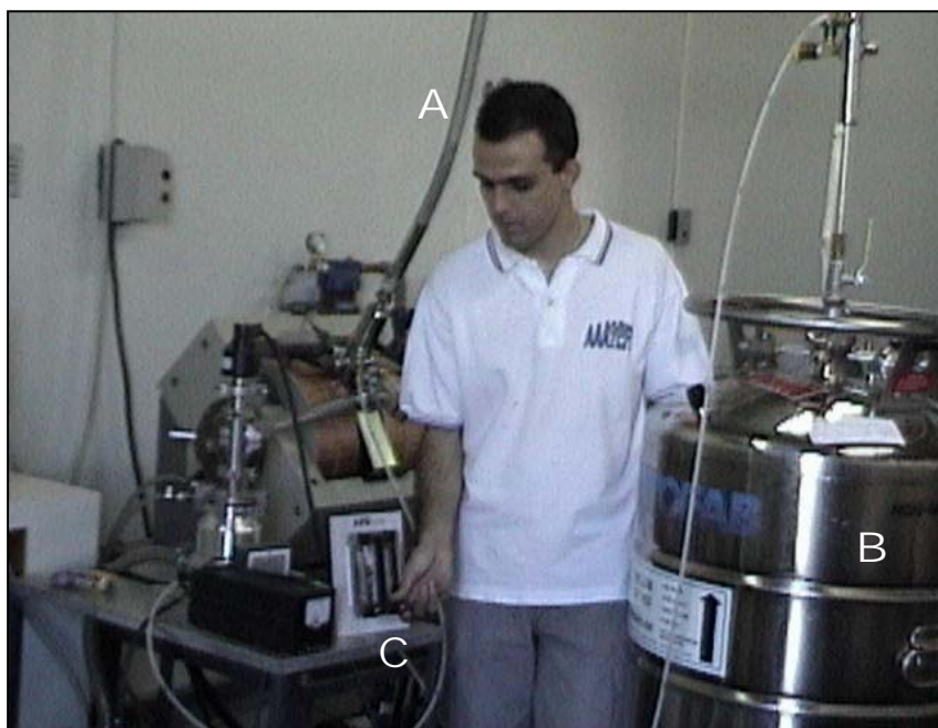
Figura 5.10 - Sistema de Criogenia: (a) tubo de transferência, (b) reservatório de He e (c) sistema de válvulas para controle do fluxo de He líquido.
