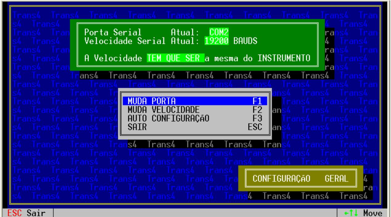
Figura 3.45: Configuração da porta serial.
