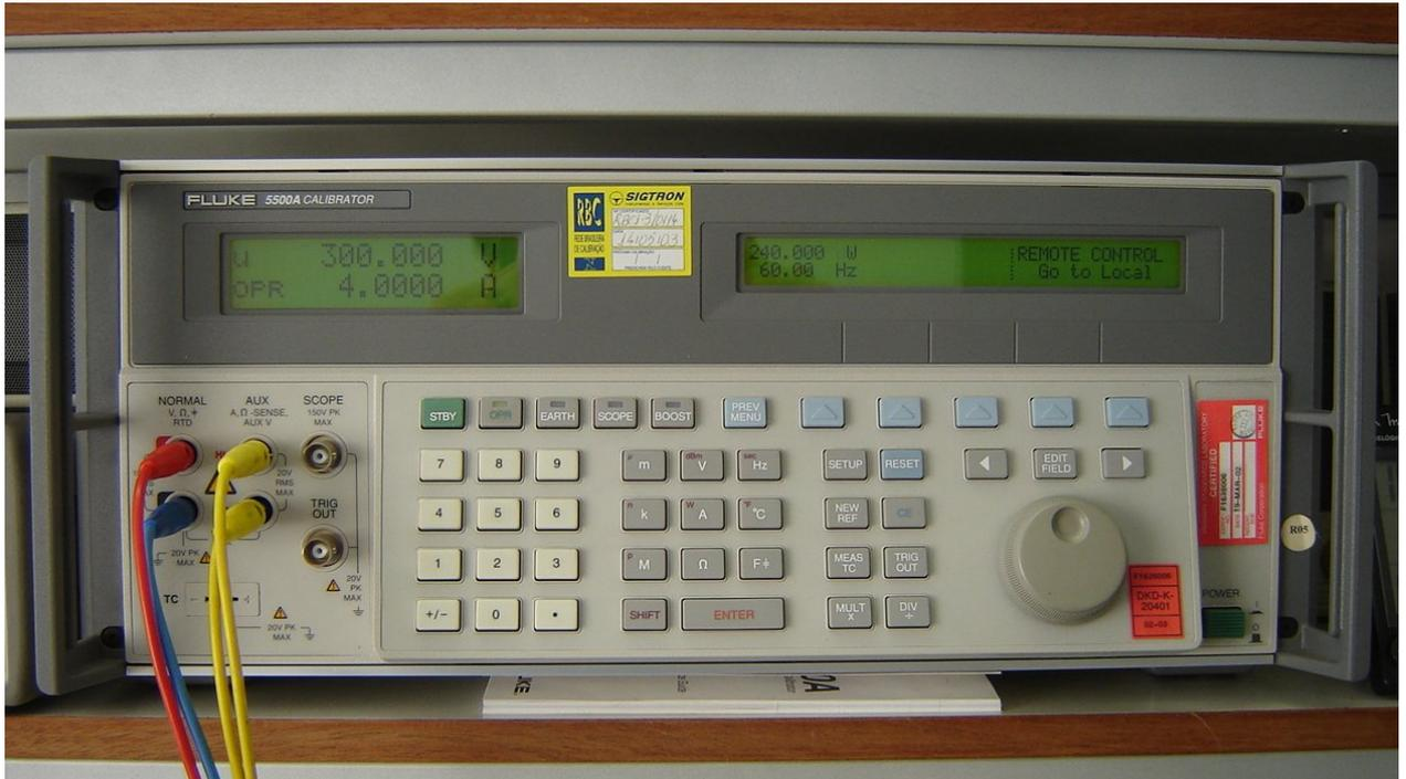
Figura 2.19: Calibrador Fluke modelo 5500A.
