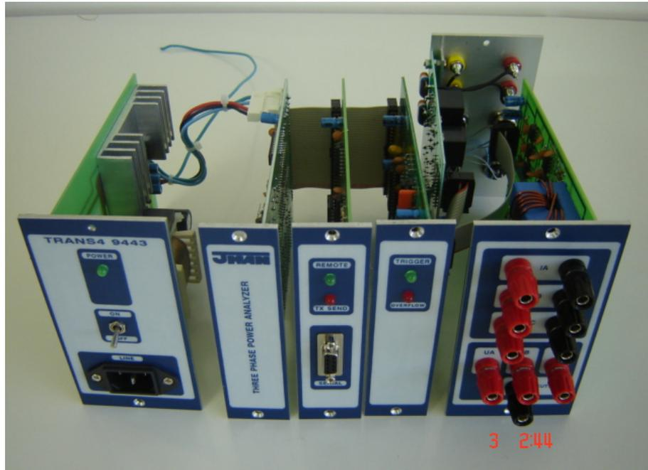
*Figura 2.14: Foto da vista frontal das placas interligadas.*
