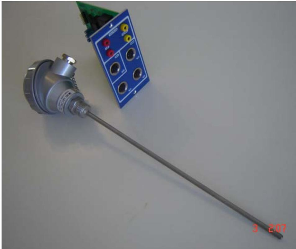
**Figura 2.13:** Foto do termômetro PT100, sem o respectivo cabo de ligação.
