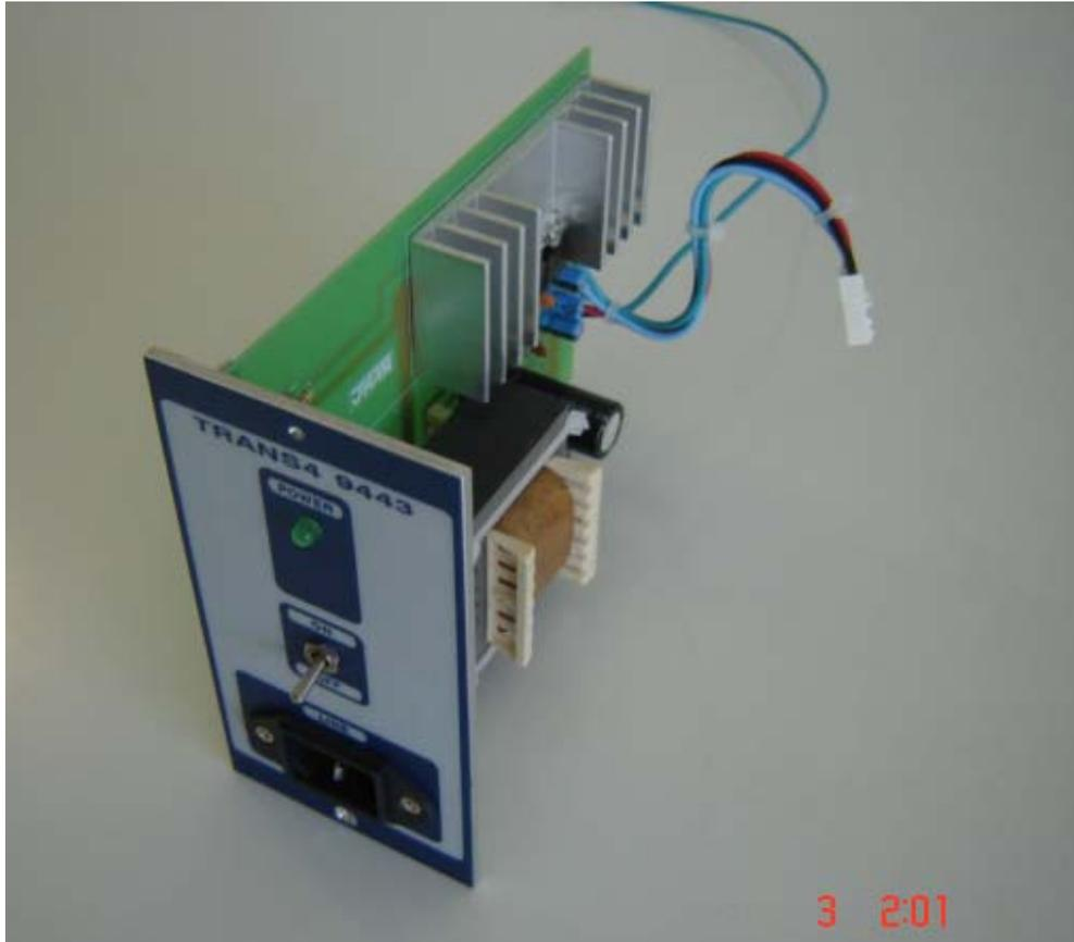
**Figura 2.2:** Foto frontal da placa 1 com as fontes de alimentação.
