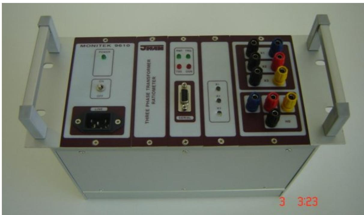
**Figura 4.10:** Instrumento MONITEK9610 completamente montado.
