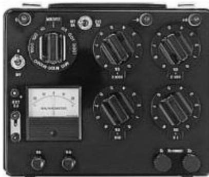
**Figura 5.4:** Ponte Wheatstone 2755 faixa de medição de 1  $[\Omega]$  a 10  $[M\Omega]$ .
