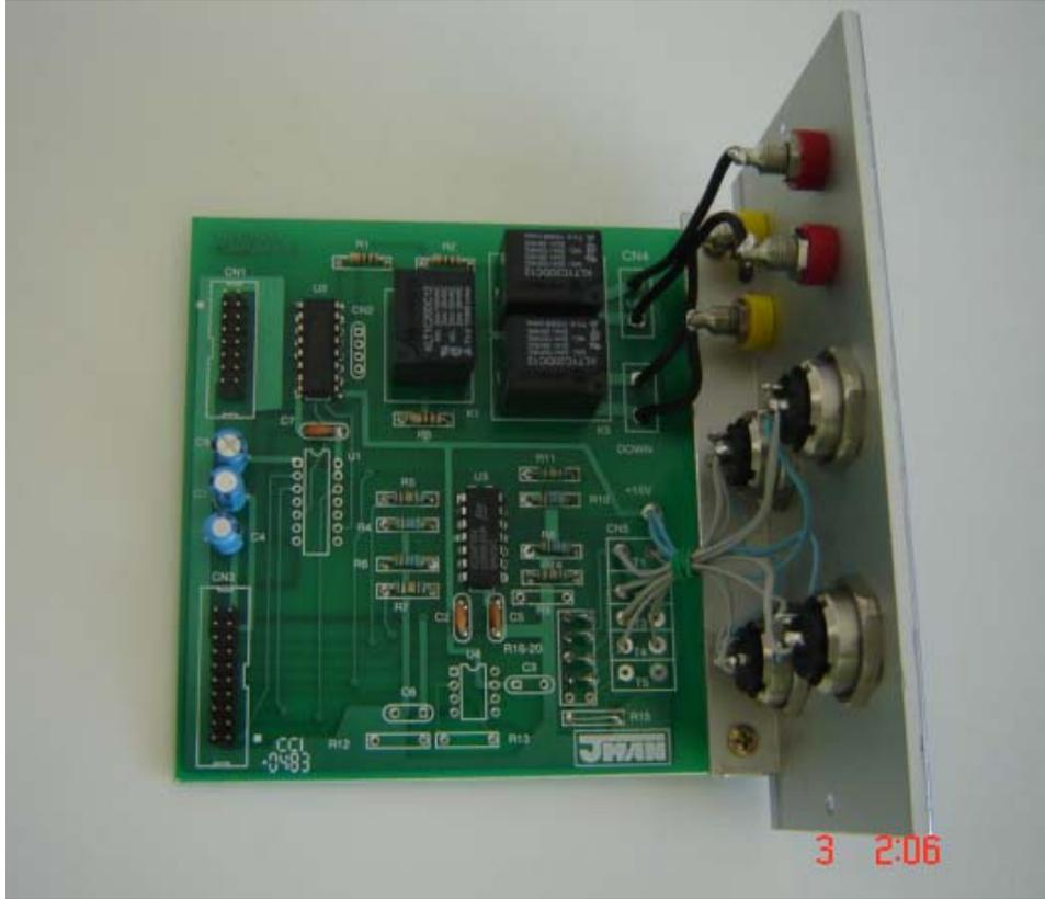
**Figura 2.12:** Foto da placa de medição de temperatura e acionamento de relés.
