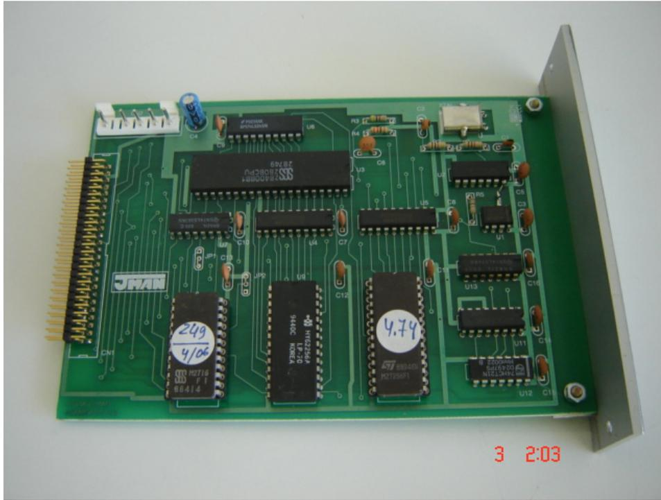
**Figura 2.3: Foto da placa da CPU.**
