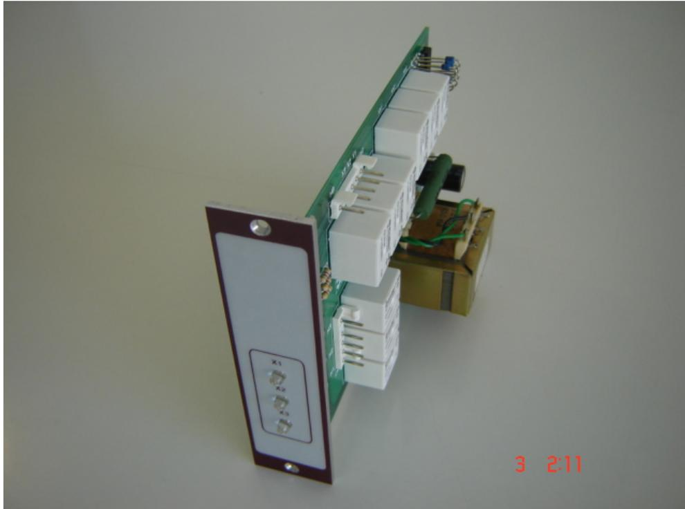
**Figura 4.4:** Foto frontal da placa 5A com a fonte e relés.
