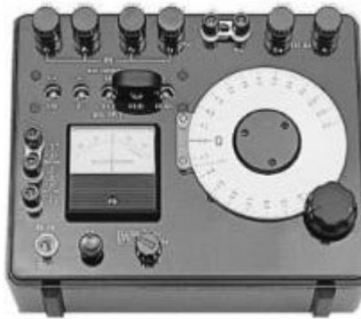
**Figura 5.3:** Ponte Kelvin 2769 faixa de medição de 0,1  $[m\Omega]$  a 110  $[\Omega]$ .
