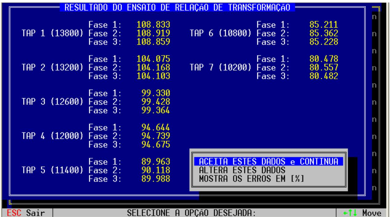
Figura 3.14: Leitura automática das medições de relação de transformação.
