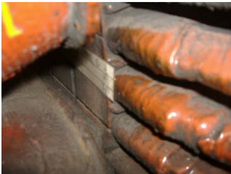
Figura 55 – Sensor capacitivo fixado na parede do estator
