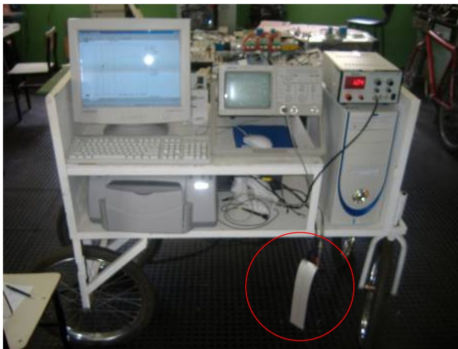
Figura 32 – Bancada de medições com capacitor suspenso no ar (em detalhe)
