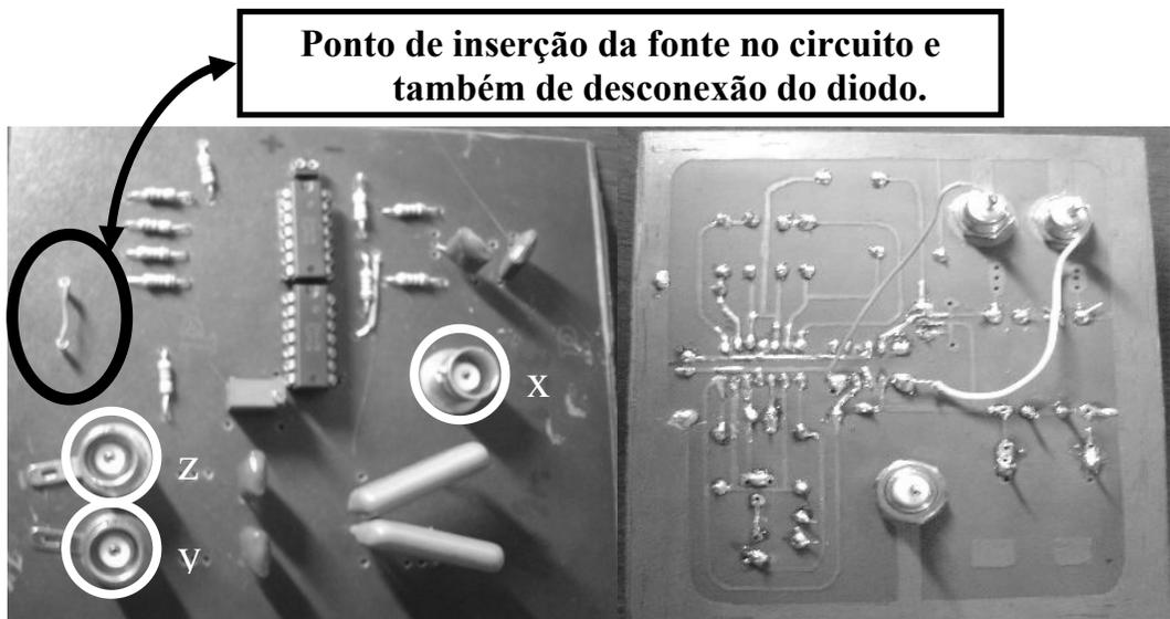
Figura 4. 2: Circuito de Chua implementado no laboratório de caracterização eletro-óptica da UNIFEI.
