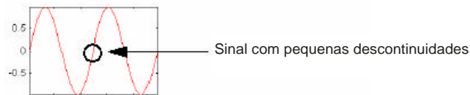
Figura 4.6 – Sinal com pequenas descontinuidades.
