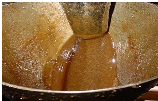
FIGURA 4.12- Fotografia do melão sendo retirado durante o processo de produção de açúcar. Fonte: (CHOHFI, 2003).
