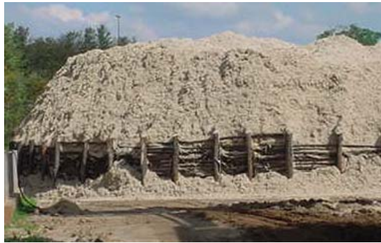
FIGURA 4.9- A fotografia mostra um depósito de bagaço, o combustível usado para geração de energia. Fonte: (CHOHFI, 2003).
