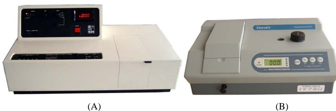
Figura 9.5: Espectrômetro UV/Vis Varian Serie 643 (A) e Biospectro SP-22 (B) utilizados para obtenção do espectro UV/Vis.
