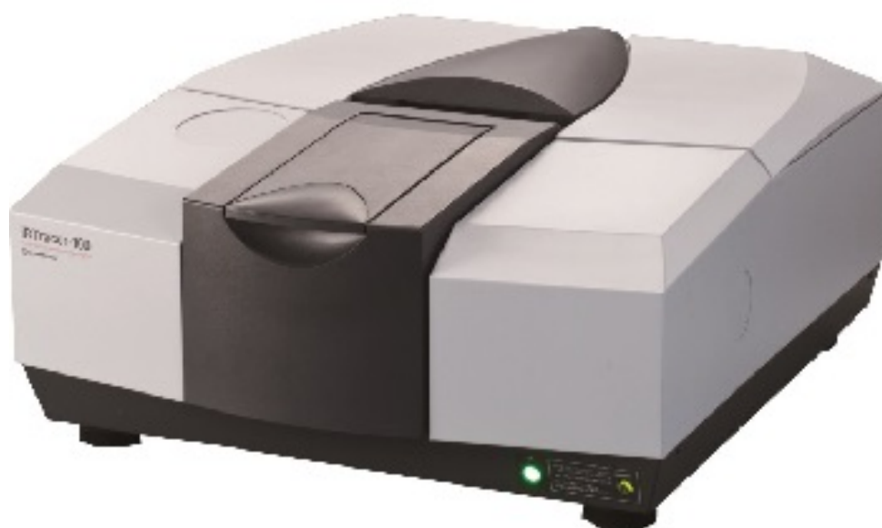
Figura 10 – Espectrômetro Shimadzu, modelo IR Tracer 100 (Laboratório de Alta Tensão)
