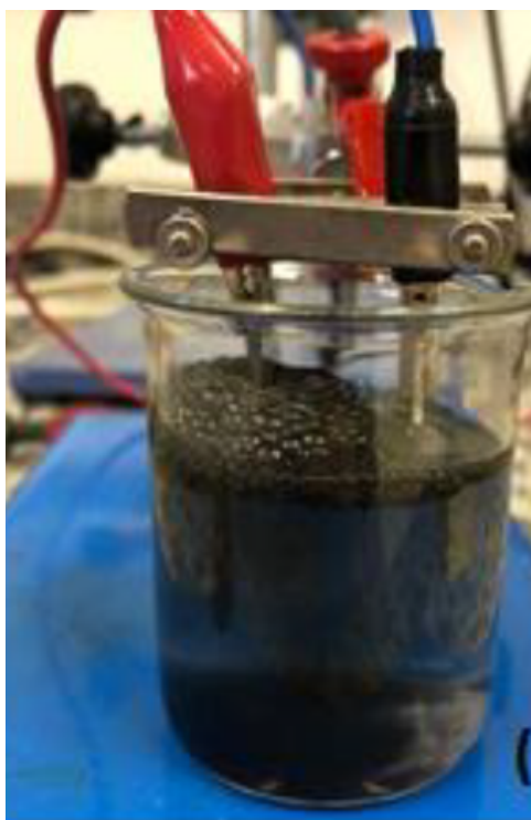
Figura 7 – Célula com eletrodos de grafite imersos em solução de ácido sulfúrico 0,1 M e Anilina. Com aumento da tensão e expansão do grafite, observa-se a formação da espuma (OG/PANI) na superfície da solução eletrolítica.
