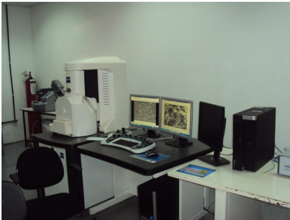
Figura 11 – Microscopia eletrônica de Varredura Superscan SSX-550 SEM-EDX (Shimadzu Corporation). Fonte: [4]
