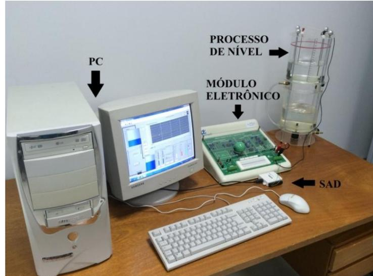
Figura 4.2 - Estrutura da bancada de ensaios
