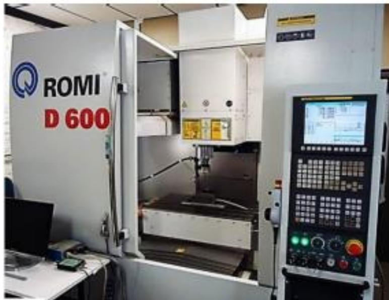
Figura 17 - Centro de usinagem ROMI® D 600
