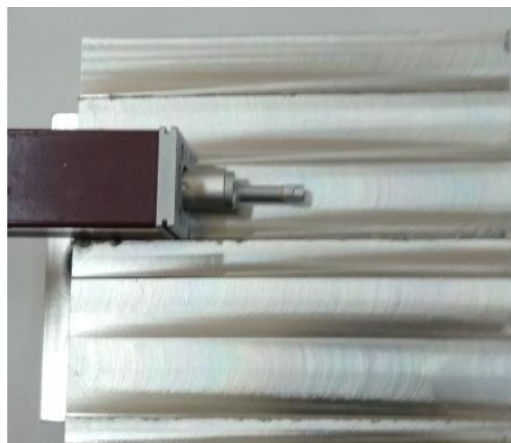
Figura 23 – Procedimento de medição da rugosidade
