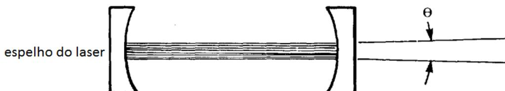
Figura 6.2 – A luz do laser faz muitas viagens de ida e volta entre os espelhos, devido a isso emerge com uma divergência muito pequena [117].
