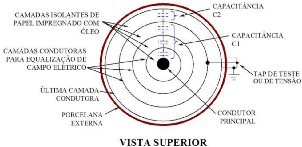
Figura 26 - Forma construtiva de uma bucha capacitiva - Fonte Tretech
