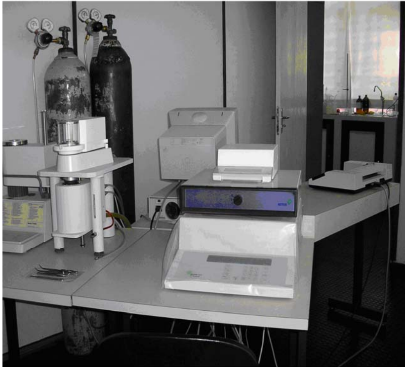
Figura 4.3 - Equipamento TGA METTLER modelo TG 50.
