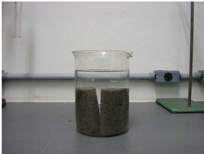
Figura 4.8 - Corpos de prova em ensaios de absorção de água por imersão.
