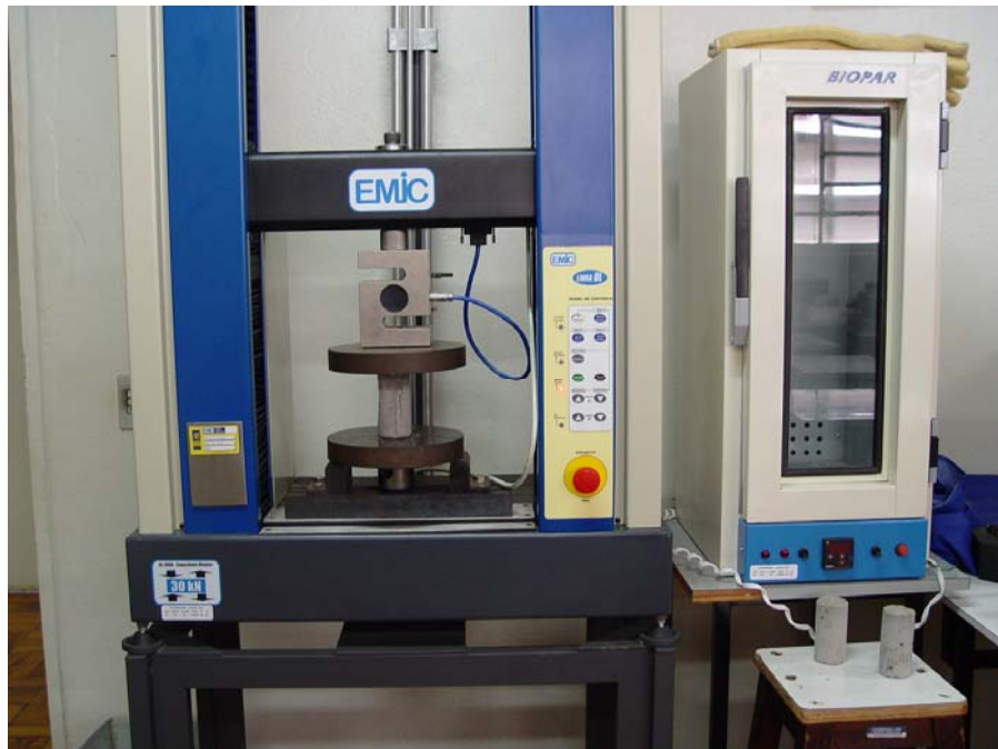
Figura 4.6 - Prensa de ensaios mecânicos utilizada neste trabalho.
