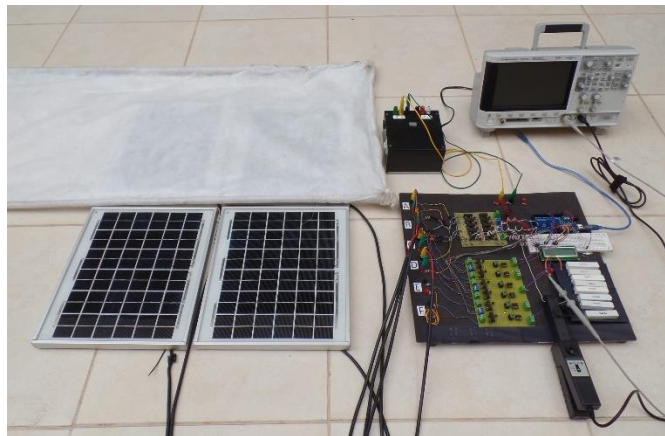
Fig. 7.9 – Bancada de testes do sistema de reconfiguração 2x2 - sombreamento artificial criado com o uso de TNT.
