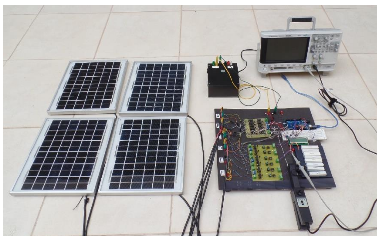
Fig. 7.8 – Arranjo experimental do sistema de reconfiguração para a matriz 2x2.
