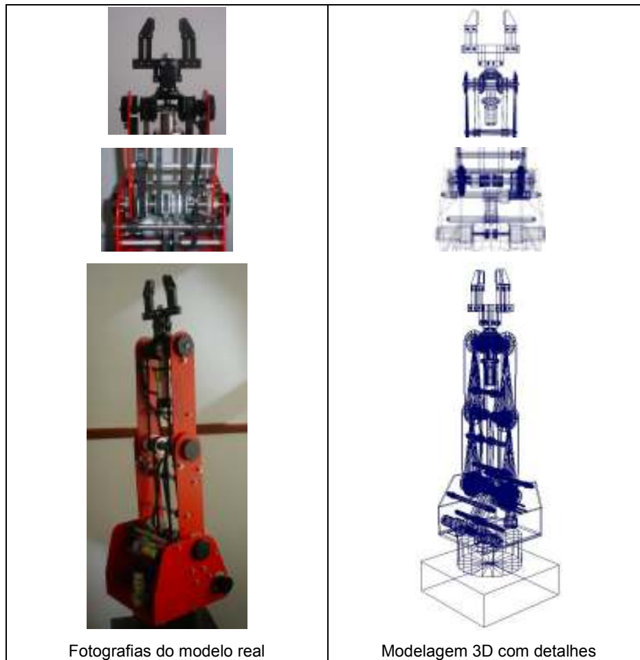
Figura 3 – Algumas representações do Braço Mecânico [3].
