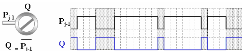
Figura 38- Resposta da Instrução Bobina Inversa (NEG).
