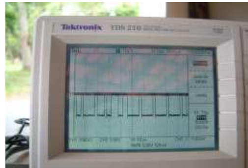
Figura 8.29 - Sinal do barramento CAN
