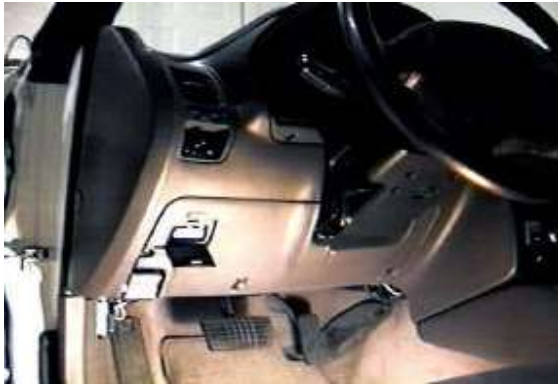
Figura 7.9-Localização do OBDII
