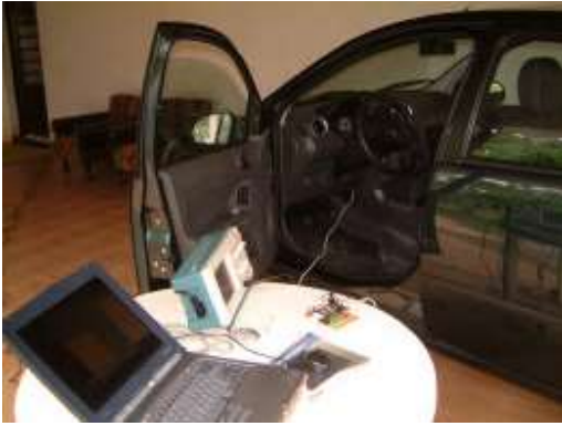
Figura 8.26- Ligação carro – bancada
