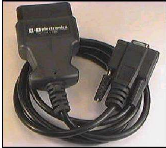
Figura 7.11-Detalhe do chicote CAN[ 6]
