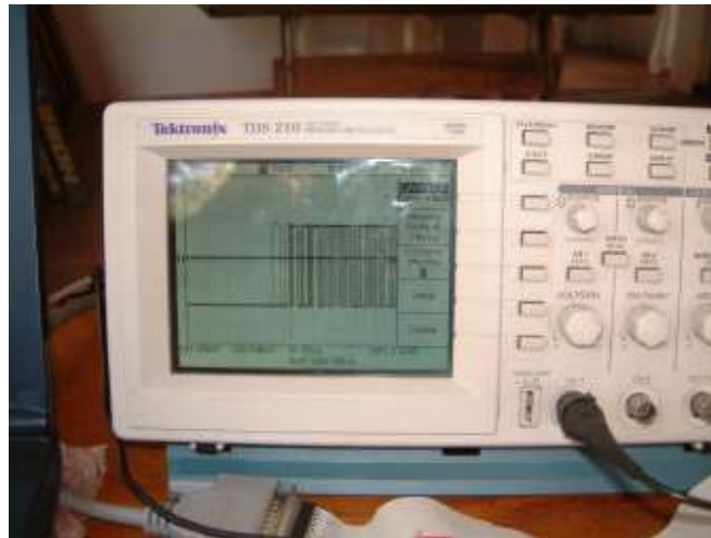
Figura 7.4 - Oscilograma do sinal de sincronização no MCU-CAN
