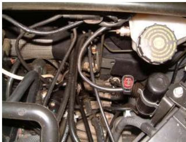
Figura 8.31 - Simulação de sensor aberto – nível de óleo de freio
