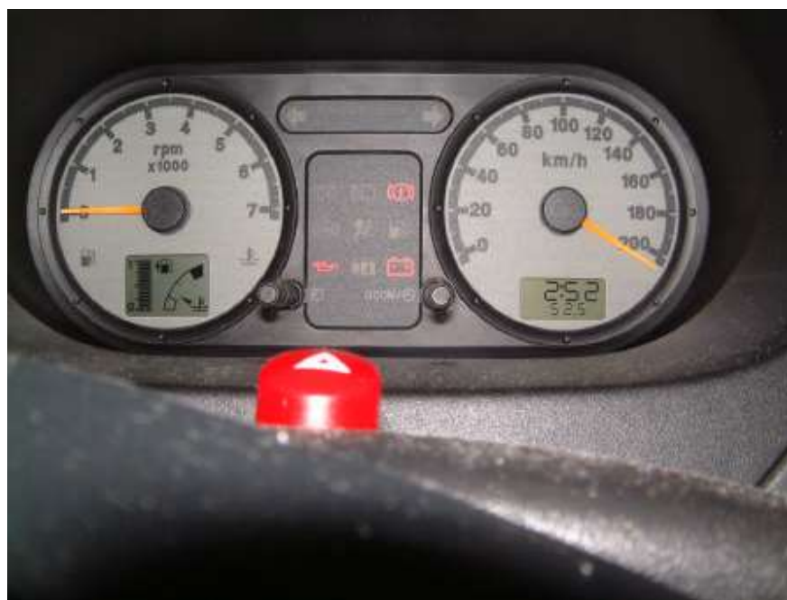
Figura 8.35- Resultado da transmissão do frame que identifica velocímetro – valor digital máximo
