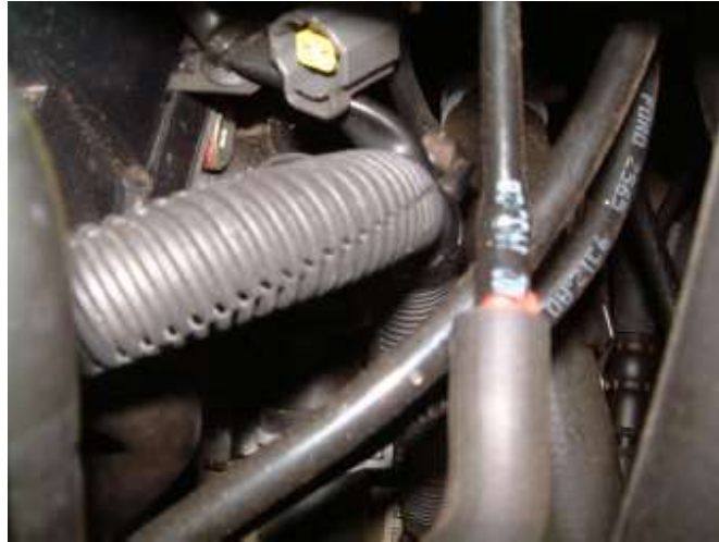
Figura 8.32 - Simulação do sensor aberto temperatura do ar de admissão
