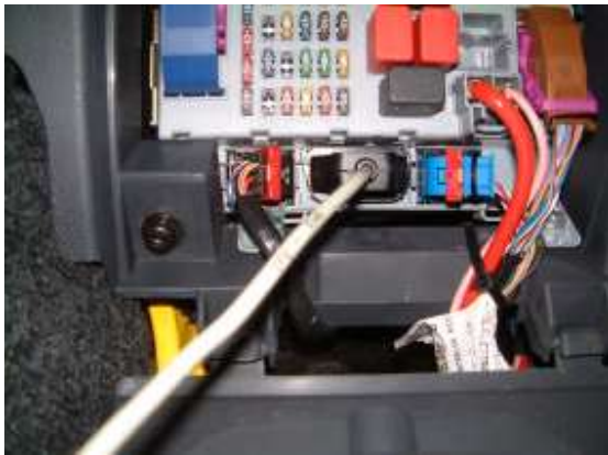
Figura 8.13-Ligação chicote CAN
