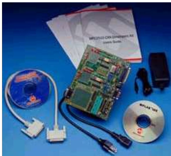
Figura 5.1-Kit de desenvolvimento CAN[ 9]
