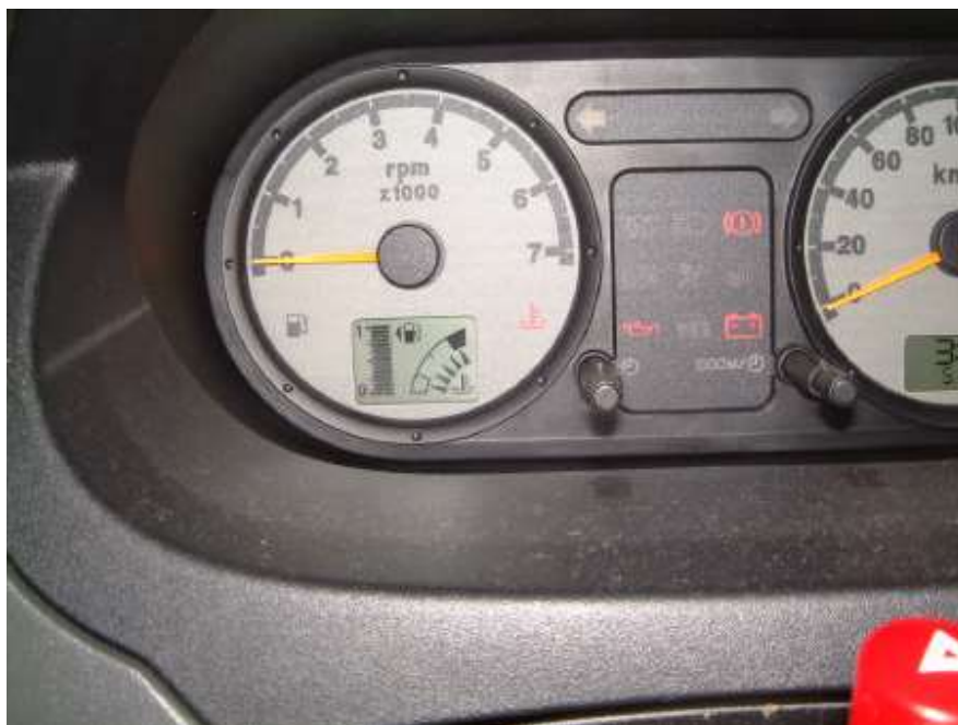
Figura 8.33 -Transmissão do byte D0=255D - Indicador digital de temperatura indicando máxima temperatura no motor
