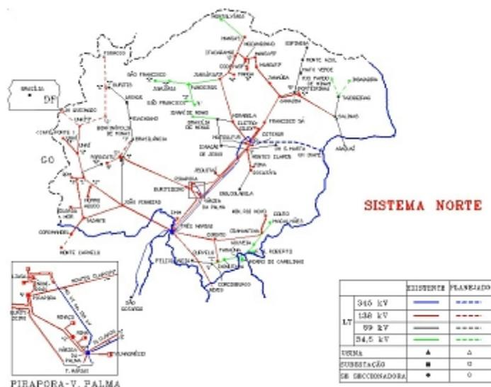
Figura 6.14: Sistema Elétrico Região Norte
