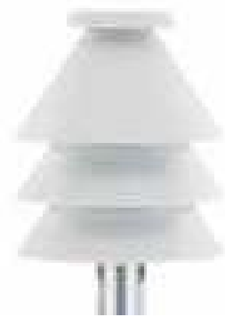
Figura 4.1: Sensor de temperatura e umidade relativa do ar utilizado nas PCDs do INPE.
