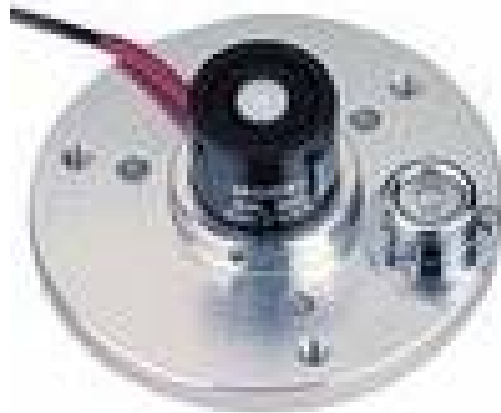
Figura 4.3: Sensor de radiação solar global utilizado nas PCDs do INPE.
