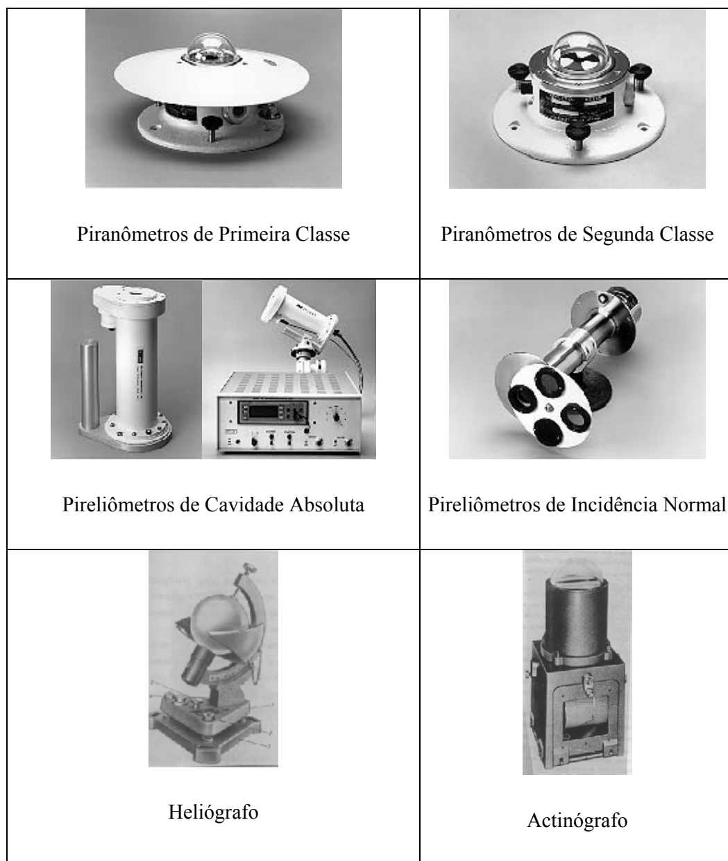
Figura 2.16: Instrumentos solarimétricos (CRESESB, 2003).
