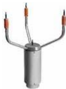
Figura 4.2: Sensor ultra-sônico do vento utilizado nas PCDs do INPE.
