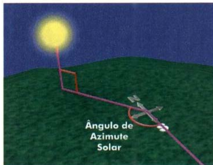
Figura 2.13: Ângulo de azimute solar (CEST, 2003).
