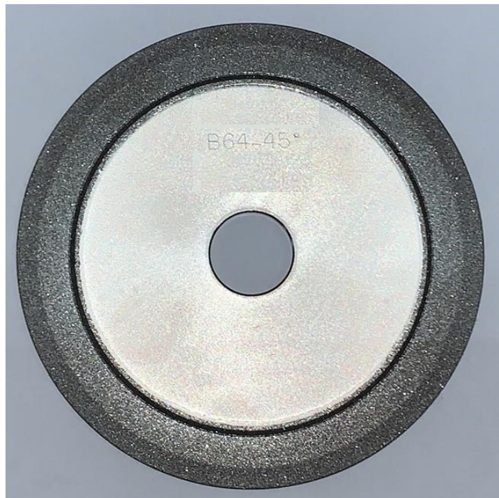
Figura 21 – Exemplo de rebolo utilizado no experimento
