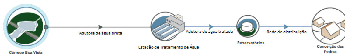
Figura 36 - Unidades do sistema de abastecimento de água de Conceição das Pedras
