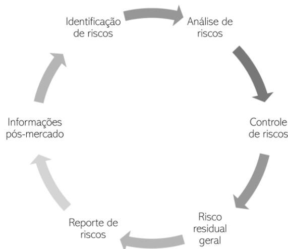
Figura 2.2: Gerenciamento de riscos na norma ISO 14971 (adaptado de ABNT, 2020)
