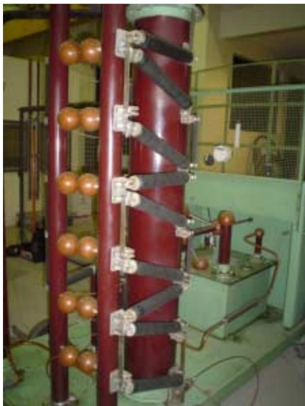
*Figura 4.16 – Gerador de Impulsos HAEFELY 450kV, 1.2kJ da Universidade Federal de Itajubá – conexão 3S-2P*
