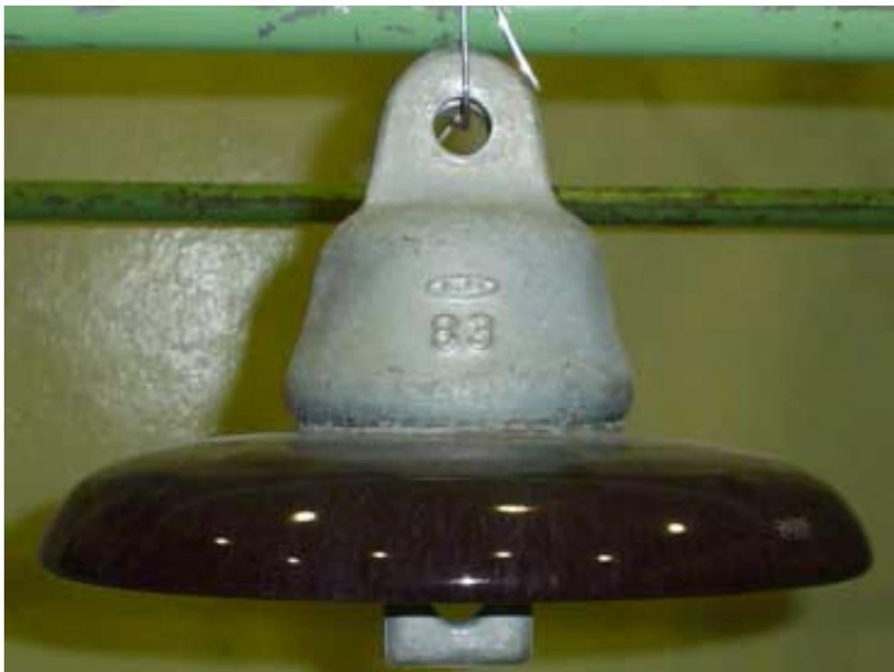
Figura 7.4 – Isolador de Suspensão
