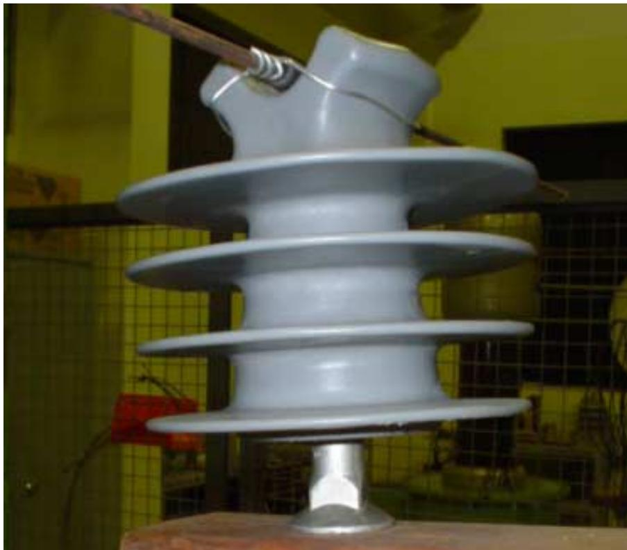
Figura 7.5 – Isolador Polimérico
