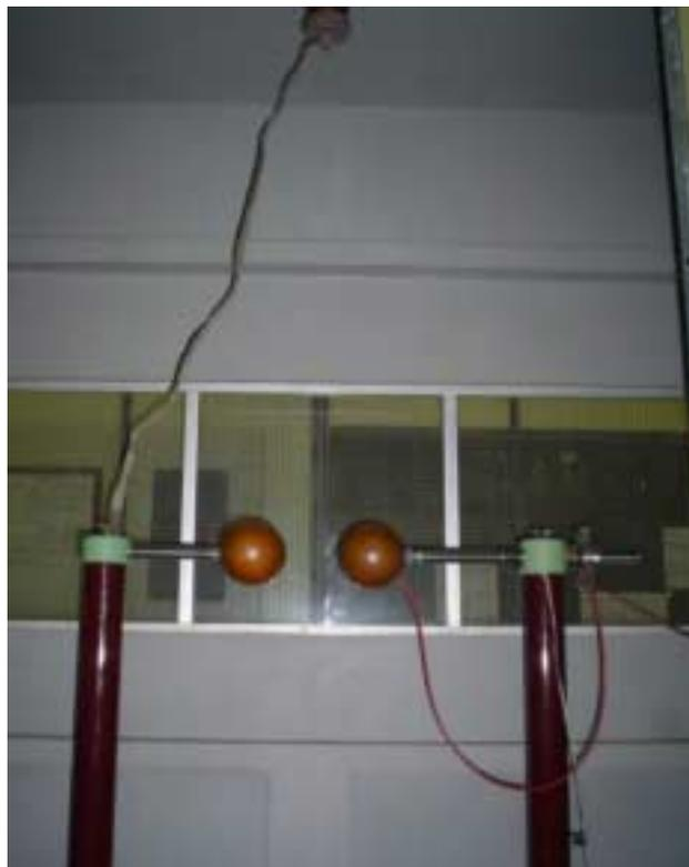
Figura 6.4 - Foto dos eletrodos Esfera – esfera dentro da Câmara de Nevoa Salina
