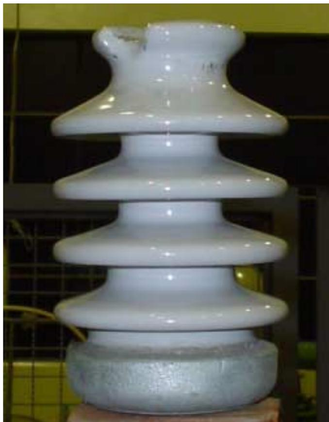
Figura 7.6 – Isolador Pilar
