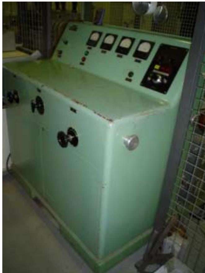
Figura 4.15 – Gerador de Impulsos HAEFELY 450kV, 1.2kJ da Universidade Federal de Itajubá - comando
