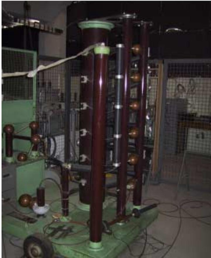
Figura 6.3 - Foto do Gerador de impulsos vista de trás com a conexão - capacitores
