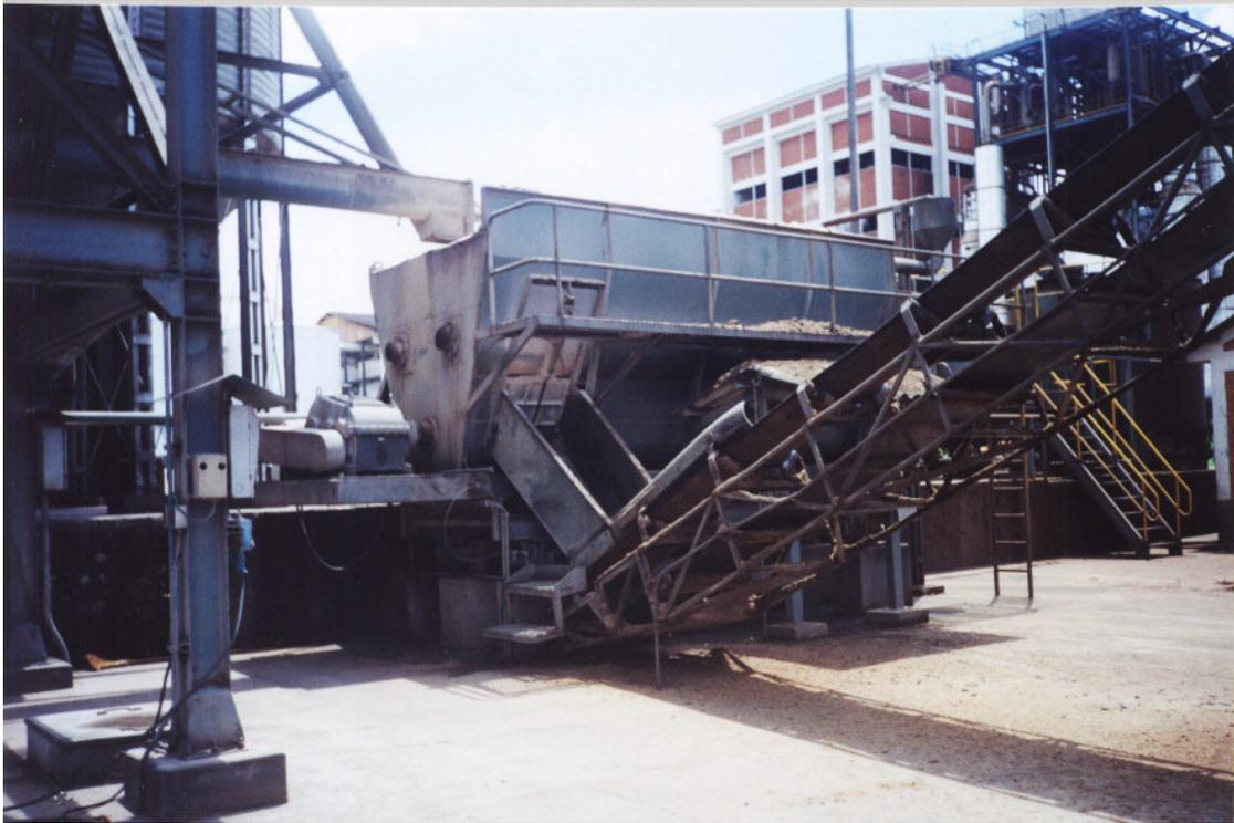
**Figura 2 – Misturador de Componentes de Ração Bovina a base de Bagaço Hidrolisado**
