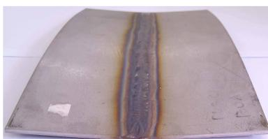
(a) deformação transversal a solda
