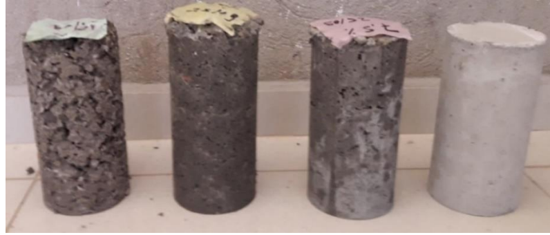
Figura 3.6: Corpos de prova confeccionados com misturas contendo (da esquerda para a direita) 100%, 50% 7,5% e 0% de e-waste
