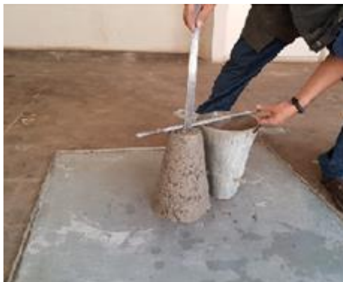
Figura 3.10: Teste de slump para o traço 06 sem substituir o cimento Portland por cinzas volantes
