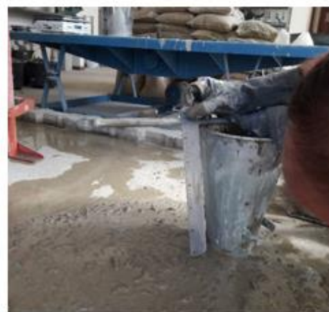
Figura 3.5: Medição do slump do concreto utilizado para confeccionar os corpos de prova
