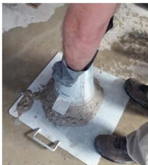
Figura 3.5: Medição do slump do concreto utilizado para confeccionar os corpos de prova
