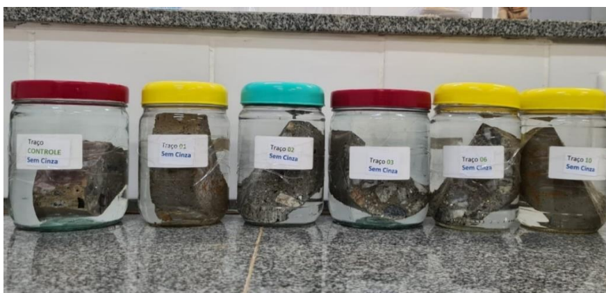
Figura 3.15: Preparação das amostras de concreto cujas resistências o classifica como concreto estrutural para ensaios de lixiviação
