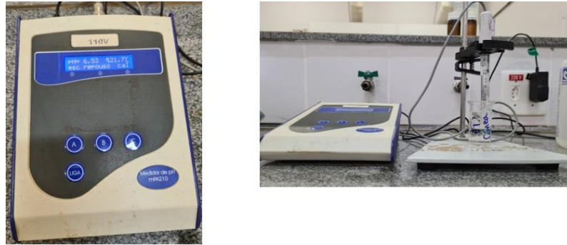
Figura 3.16: Equipamentos utilizados para medir o pH da água das amostras do concreto cujas resistência o classifica como concreto estrutural
