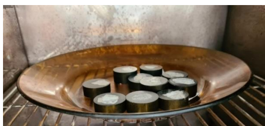
Figura 3.11: Amostras de concreto preparadas para ensaio de MEV
