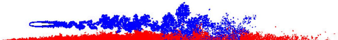
Figura 33 – Esteira para o aerofólio NACA 0012, com ângulo de ataque nulo, posicionado à  $h = 0,60$ .
