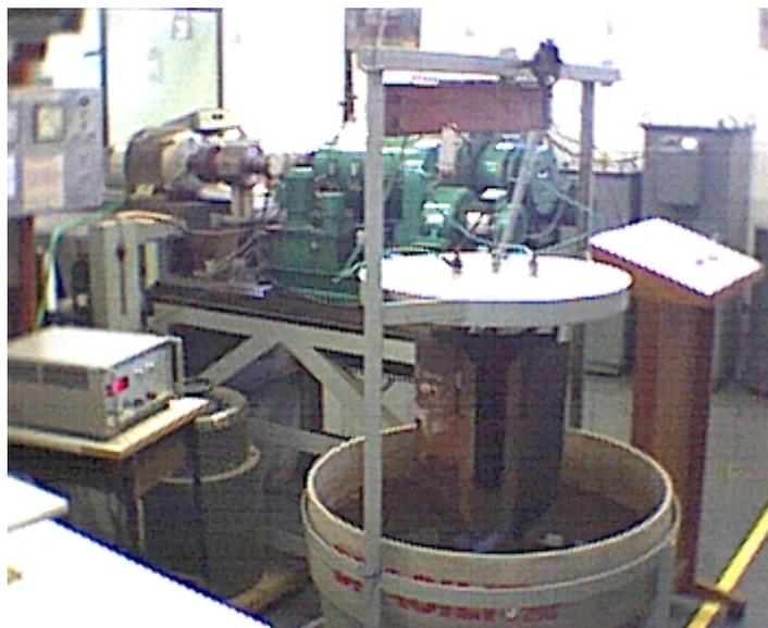
Figura 8-2 – Pás Funcionando como Carga para a Máquina de Corrente Contínua.
