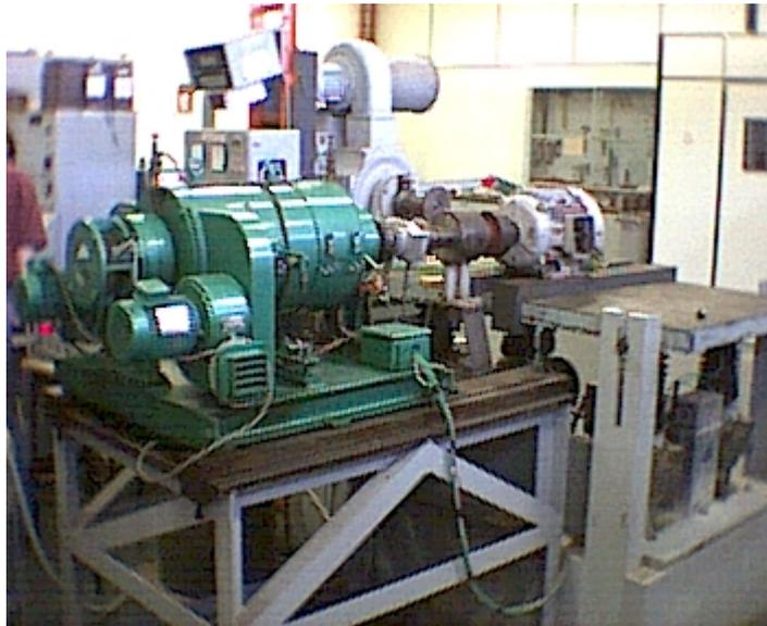
Figura 8-1 – Máquina de Corrente Contínua Acoplada ao MIT
