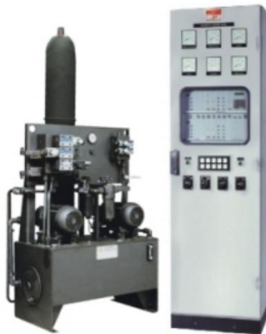
Figura 7.2 - Regulador de Velocidade Digital RVX
