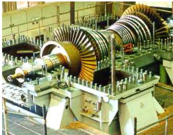
Figura 3.26 - Vista geral de uma turbina a vapor da Alstom Power.
