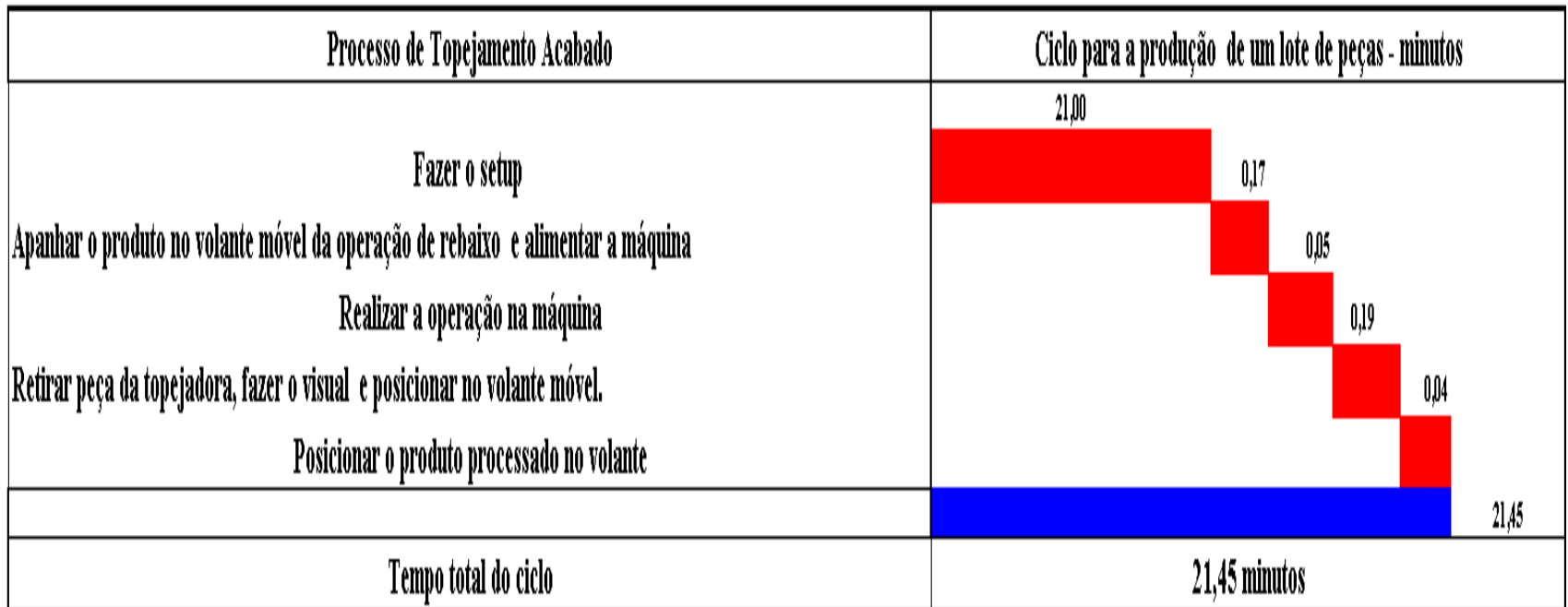
Figura A 14 – diagrama homem-máquina para o processo de topejamento.
