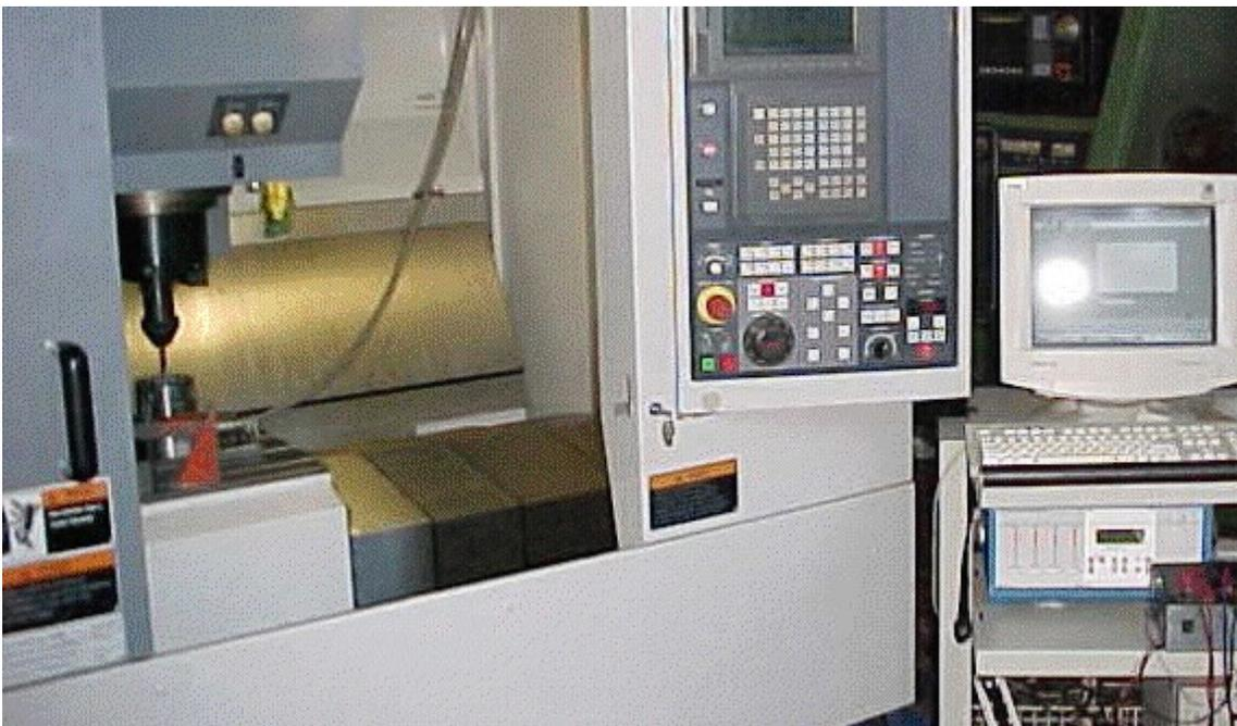
Figura 4.1- Centro vertical de usinagem e sistema de medição de potência usados nos experimentos em laboratórios.
