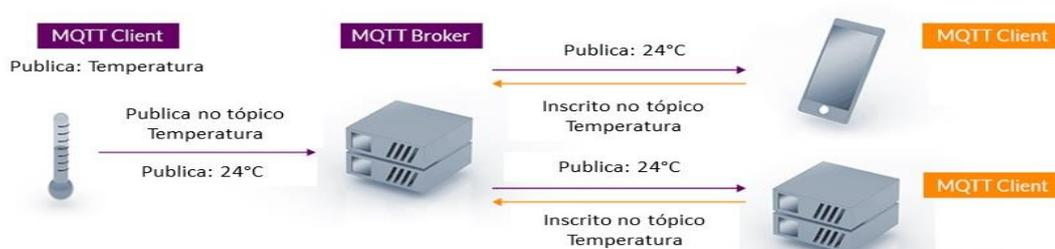
**Figura 6: Comunicação MQTT. Fonte: Mqtt (2021).**
