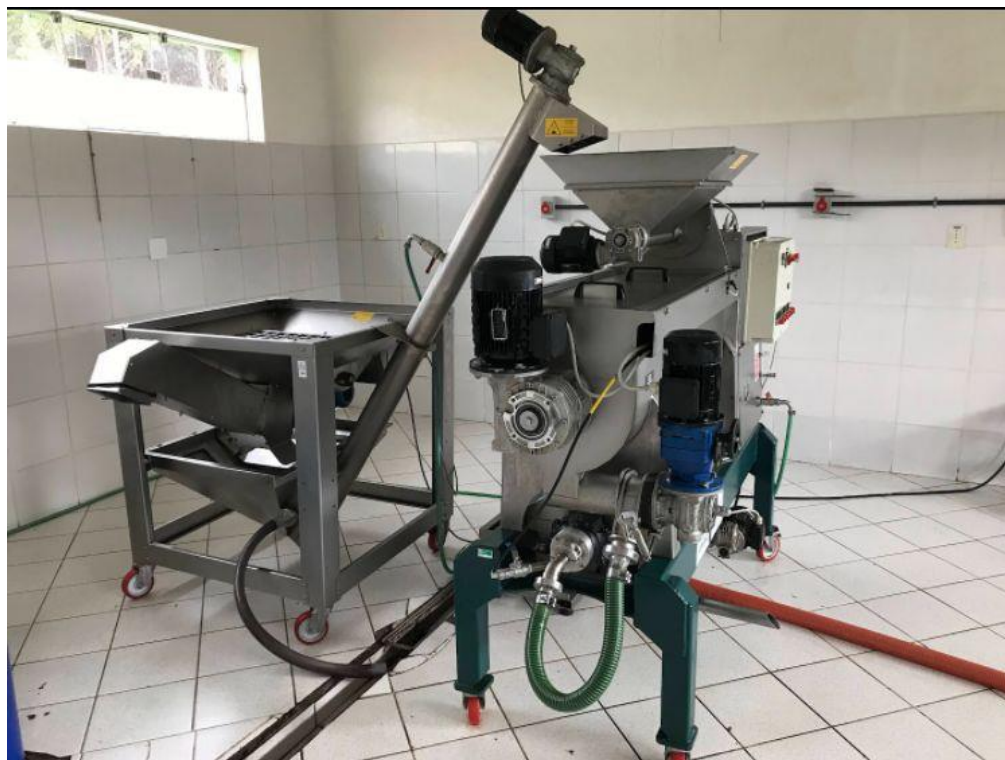
FIGURA 3.3 - SISTEMA DE EXTRAÇÃO DE AZEITE
