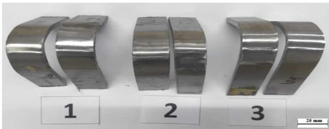
Figura 35 - Corpos de prova após ensaio de dobramento guiado 180°. 1 amostras de 4,2 kJ/cm, 2 amostras de 6,7 kJ/cm e 3 amostras de 9,1 kJ/cm.
