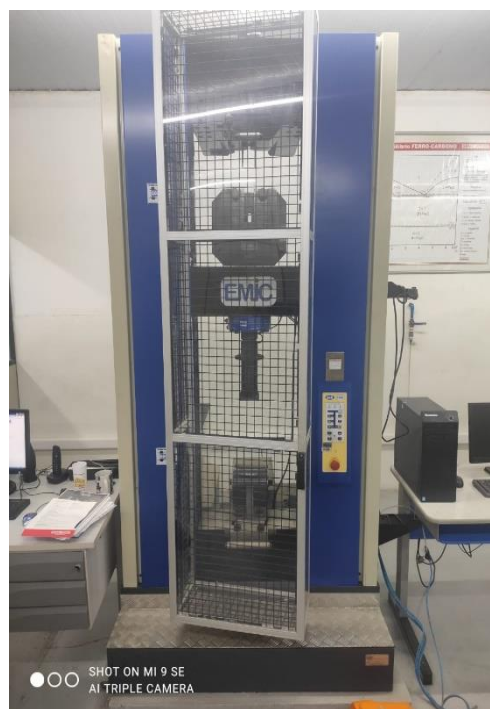
Figura 23 - Máquina Universal de ensaios EMIC 600.
