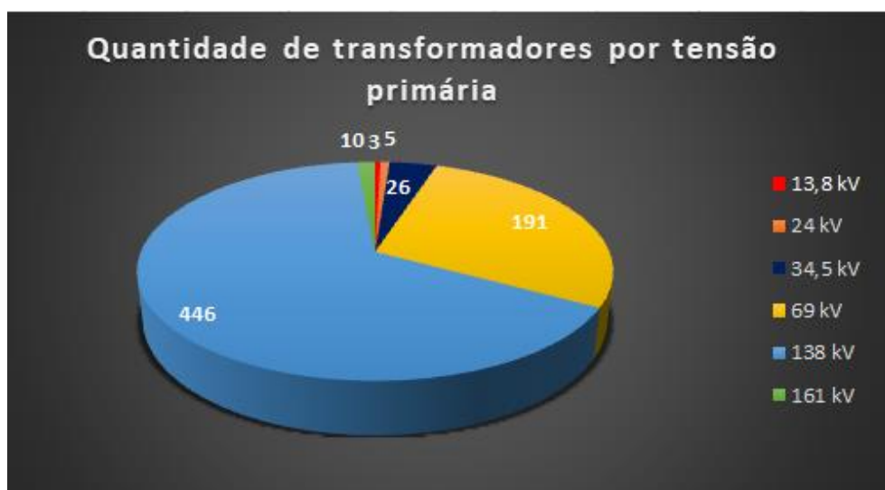
Figura 4.2 – Quantidade dos transformadores por tensão primária.
