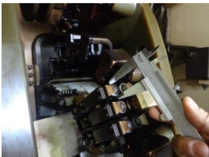
Figura 2.26 – Medição das dimensões de contato móvel de CDC [31].
