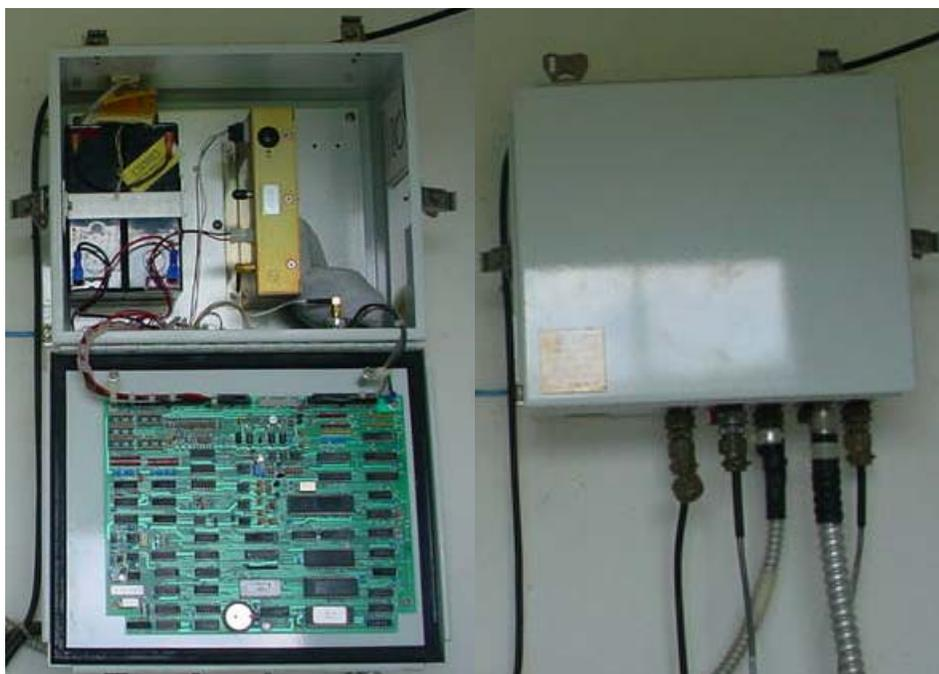
Figura 3.2.6 – Plataforma de Coleta de Dado – PCD, com sistema de alimentação, transmissor, conectores e cabos
