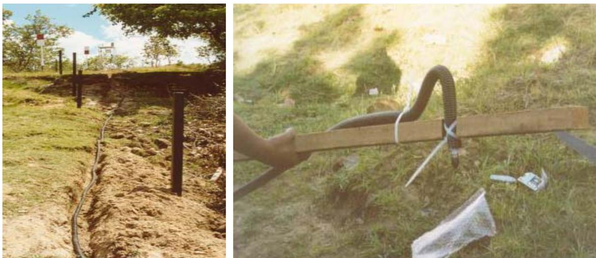
Figura 3.2.2 – Sensor de nvel com a utilizao de sensor de presso
