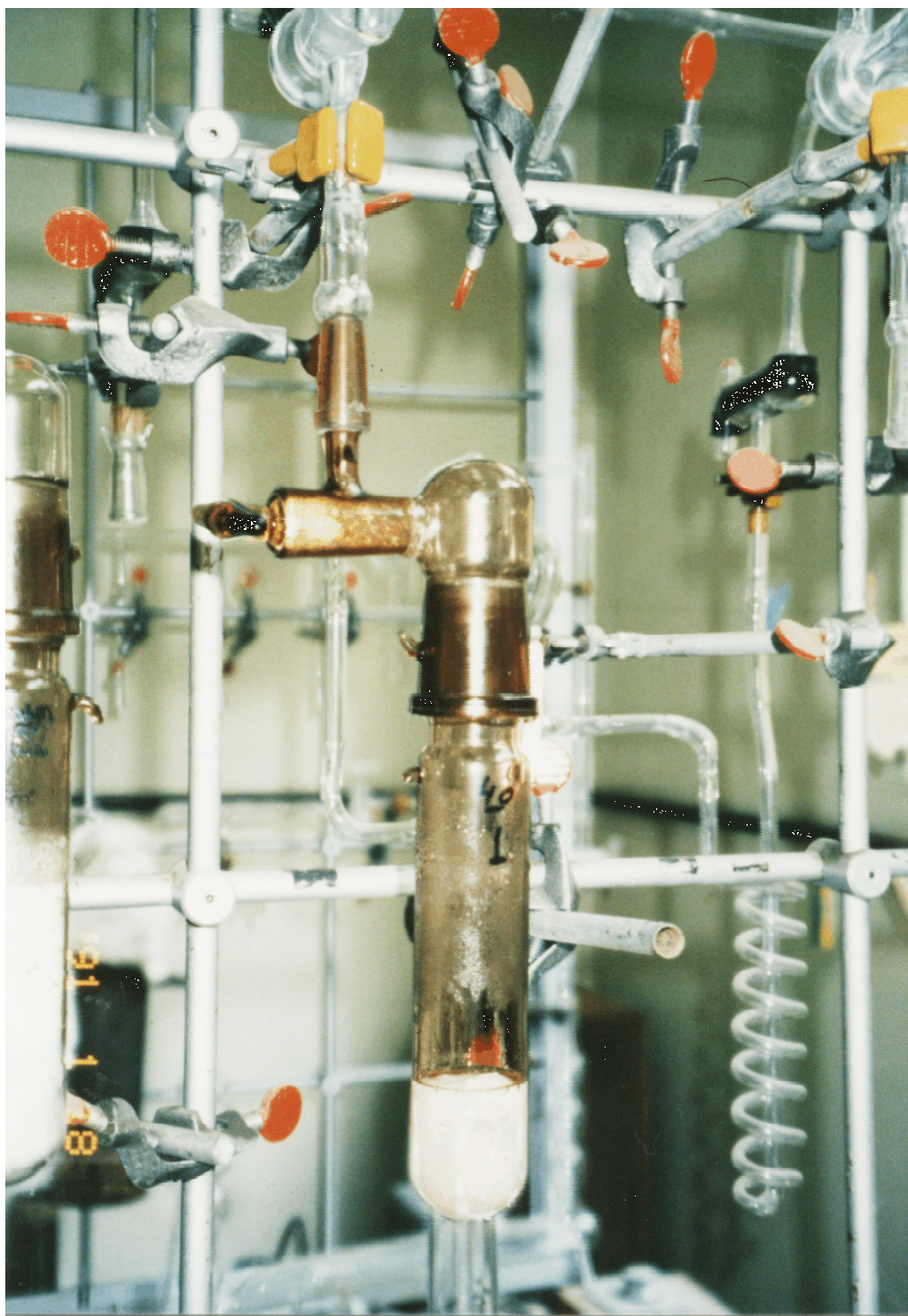
Figura 13 – Fotografia mostrando a ampola de válvula removível conectada a uma linha de alto vácuo para degaseificação.
