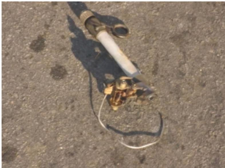
Figura 3.12- Exemplo de um elo fusível rompido
