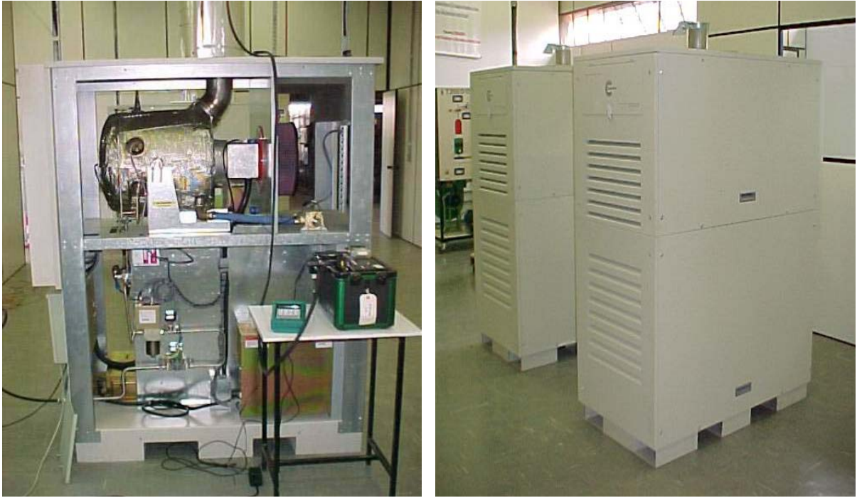
Figura 2.8 – Foto da microturbina a gás aberta (esquerda) e de dois módulos (direita) instalados no Laboratório de Máquinas Térmicas da UNIFEI.
