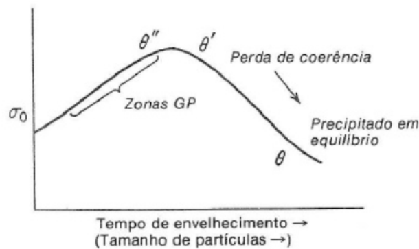
Figura 2.2 - Variação esquemática da tensão de escoamento com o tempo de envelhecimento. Fonte: DIETER (1981).
