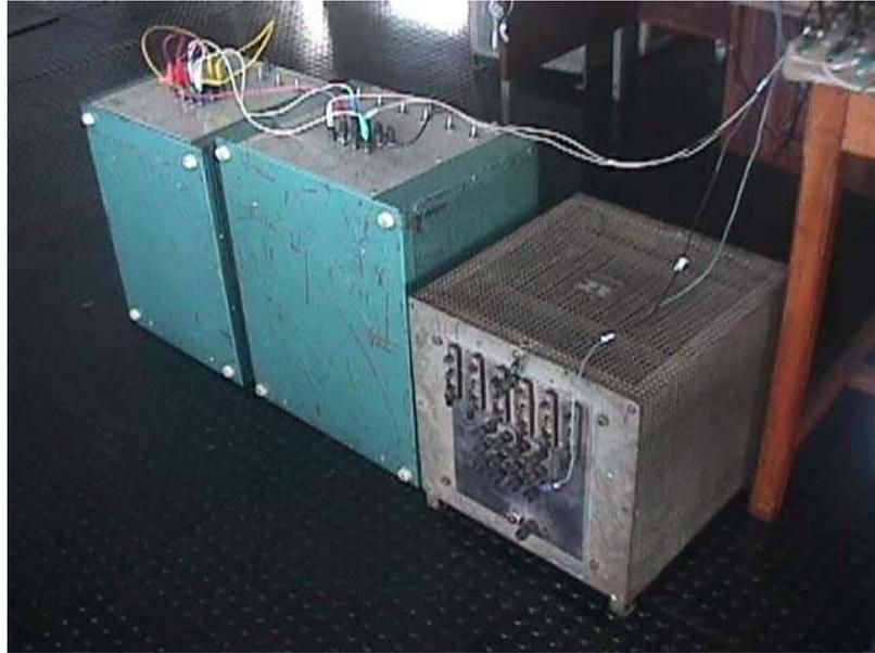
Figura 3.20 – Foto da Carga resistiva
