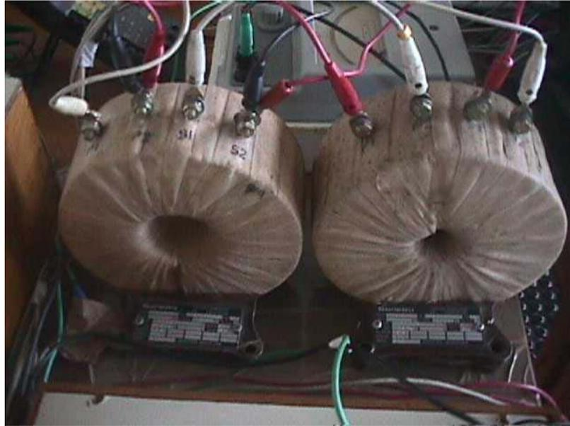
Figura 3.13 – Foto dos Transformadores de potencial.
