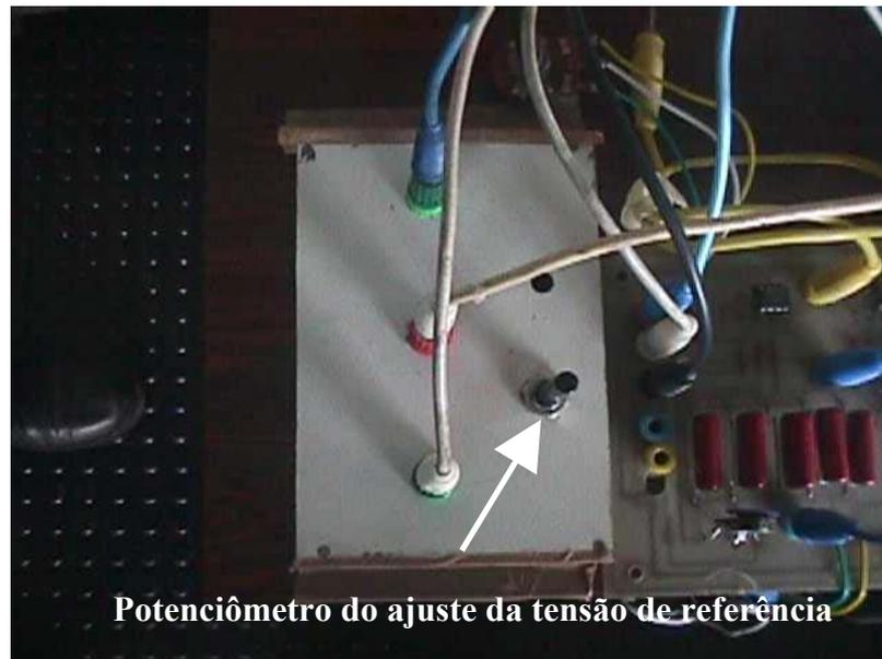
Figura 3.11 – Foto do Potenciômetro para ajustar a tensão de referência.
