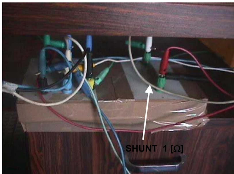
Figura II.3 – Shunt onde são posicionados os terminais do osciloscópio para obtenção da forma de onda da corrente de fase do banco de indutores.
