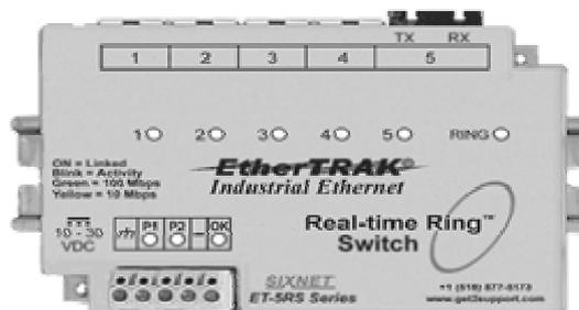
Figura 4 – *Switch* Ethernet industrial com prioridade de transmissão. <sup>[8]</sup>
