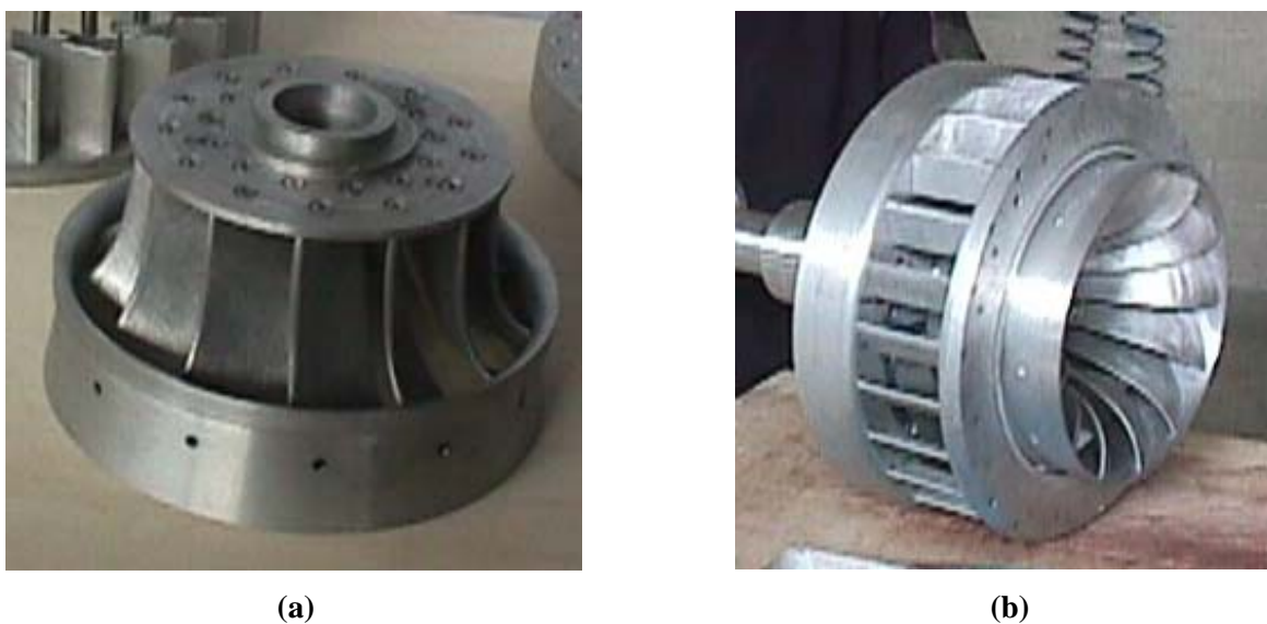
Figura 3.10 Ilustração de rotores de turbinas Francis: (a) rotor isolado, (b) rotor e distribuidor
