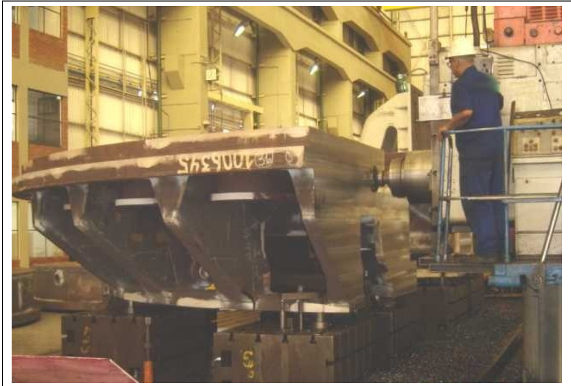
Figura 2.5: Peça montada e preparada em mandriladora pesada.
